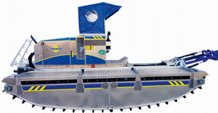
Die hydraulische, verstellbare Fahrerkabine wirkt als Gegengewicht beim Heben schwerer Lasten im Wasser.
