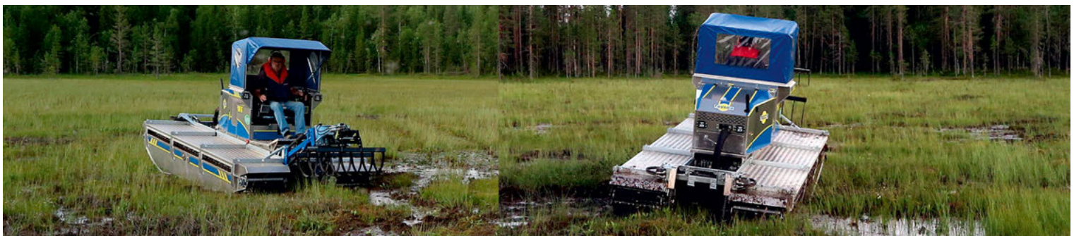
Auch auf schwierigem Untergrund sorgt das System der Gewichtsverteilung für einen niedrigen Bodendruck und gute Wadfähigkeit der Maschine.
