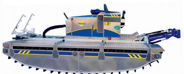
Die hydraulische, verstellbare Fahrerkabine wirkt als Gegengewicht beim Heben schwerer Lasten im Wasser.
