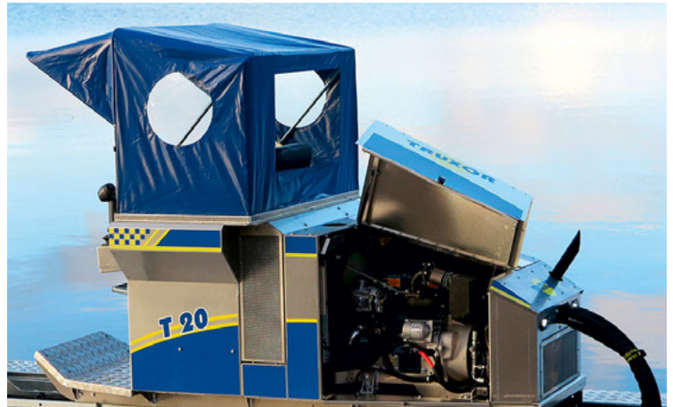
Einfacher Zugang zum Maschinenraum– mühelose Wartung.
