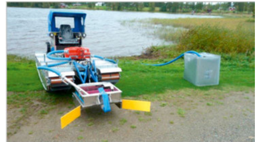
Der Doro Skimmer wird mit einer Halterung geliefert, an welcher das Absaugrohr (Sala Walzpumpe) plaziert wird.
