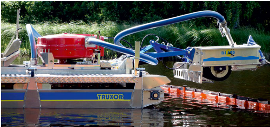
Der Doro Skimmer wird mit einer Halterung geliefert, an welcher das Absaugrohr (Sala Walzpumpe) plaziert wird.
